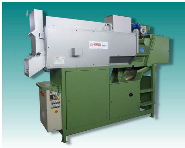
Gebraucht Gasbeheizte Schmiedeofen, mit automatischer Beschickung zur Erwärmung von Messing, Aluminium und NE-Metallen.
