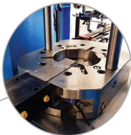
**Sistemi di fissaggio stampo idraulici autocentranti**
